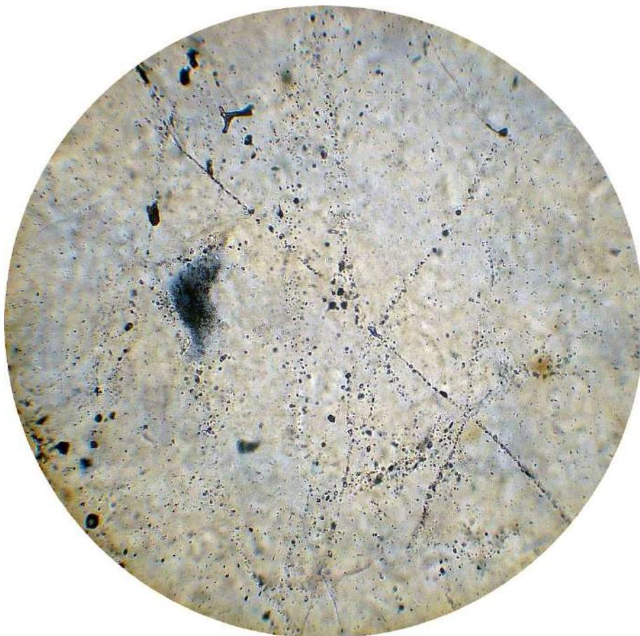
Рис.7. Блоково-волнистое центростремительное погасание зерен кварца в камне «гранит BELLA WHITE NEW». Поле шлифа 4,1 мм, анализатор включен (николи+)
