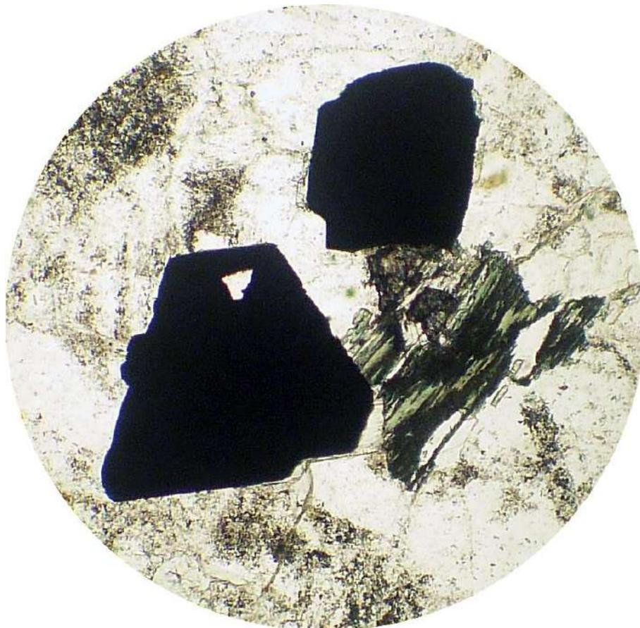
Рис.12. Шестигранные призмы поперечного сечения зерен апатита в камне «гранит BELLA WHITE NEW». Поле шлифа 0,1 мм, анализатор выключен (николи=)
